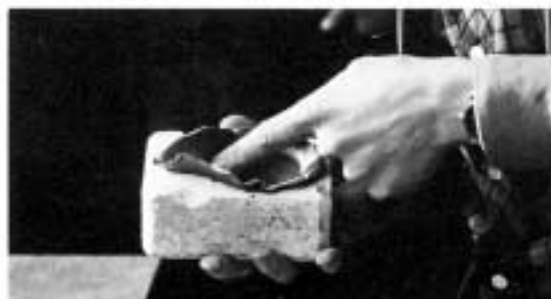
Der Unterteil der künftigen Lampe entsteht in der zweiten Gipsform
