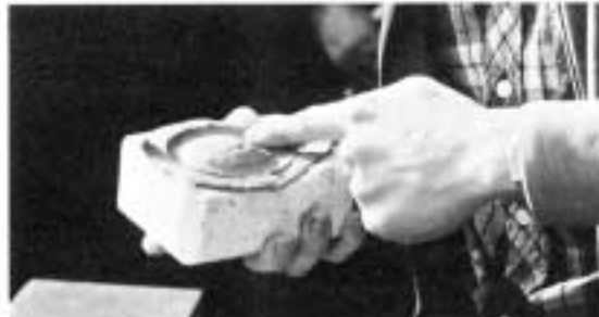
Weicher Ton wird von Hand in eine Gipsformhälfte gedrückt
