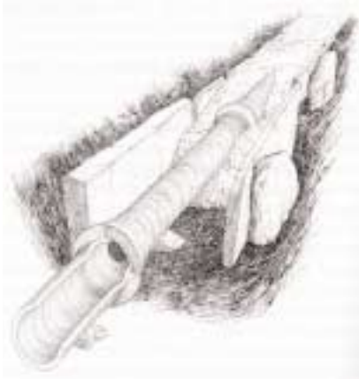
Wasserleitung aus Tonröhren in Zürich, welche das Dominikanerkloster um 1230 mit Trinkwasser versorgte. Eine derartige Wasserleitung war damals einzigartig.
